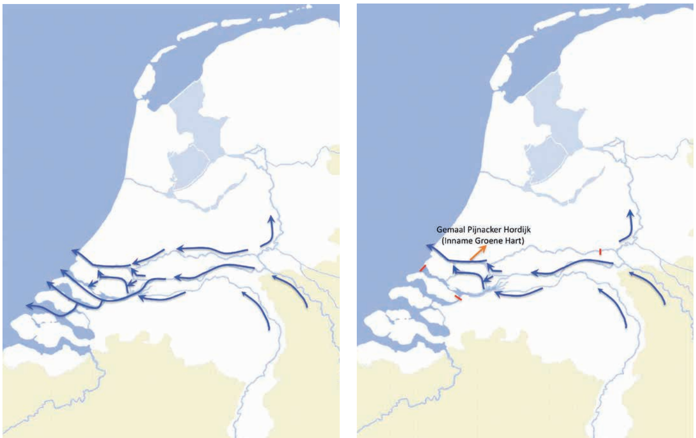
Figuur 3. Links: zo zou het water van Rijn en Maas onder natuurlijke omstandigheden naar zee stromen: via Nieuwe Waterweg, Haringvliet, Grevelingen en Oosterschelde. Rechts de huidige situatie bij gemiddelde en lage rivierafvoeren: de zeearmen zijn afgesloten en alle water wordt naar Nieuwe Maas/Nieuwe Waterweg geleid om het innamepunt voor het Groene Hart zoet te houden.
