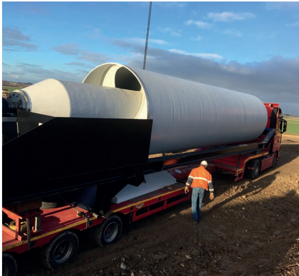
Buisvijzel met een diameter van 2,5 meter. De Delta21-buisvijzels worden vier maal zo groot.
