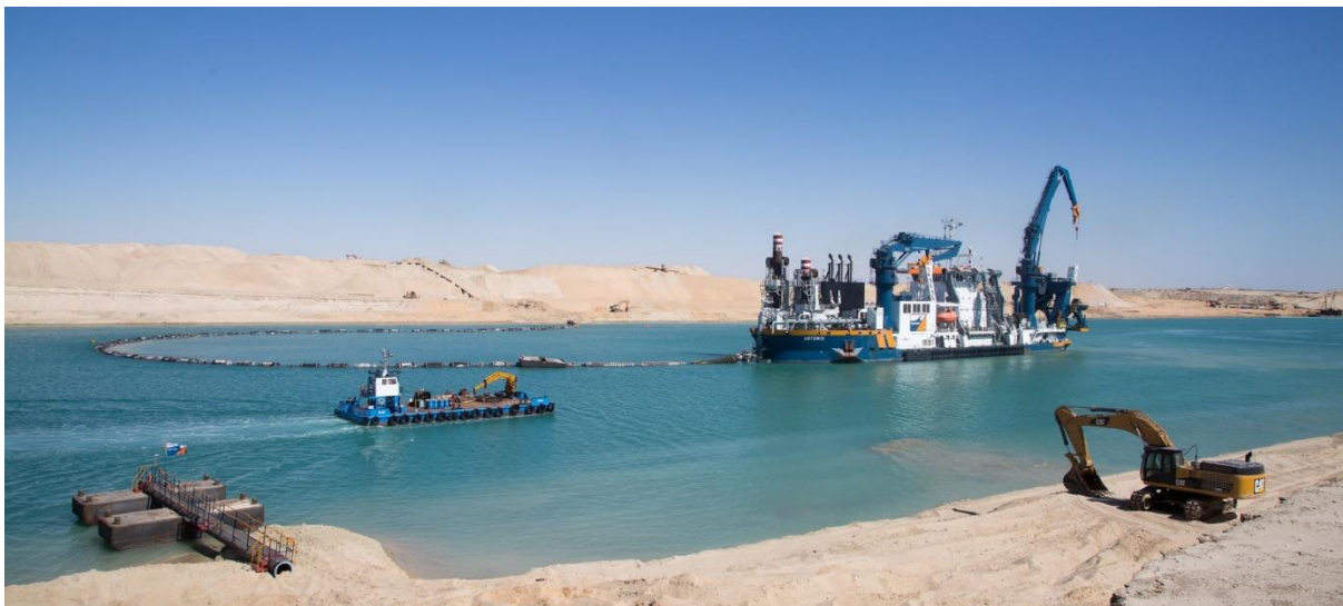
Figuur 61: Cutterzuiger met drijvende leiding (VanOord, 2019).
