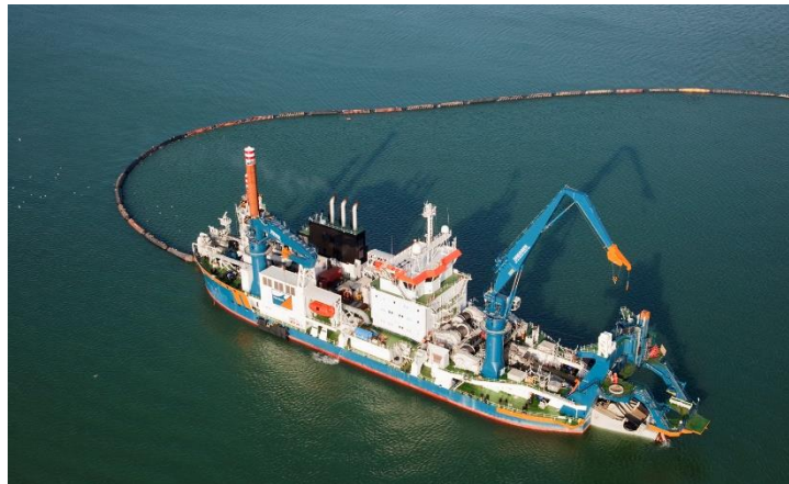
Figuur 62; Cutterzuiger (CSD) Athena (Van Oord, 2019).
