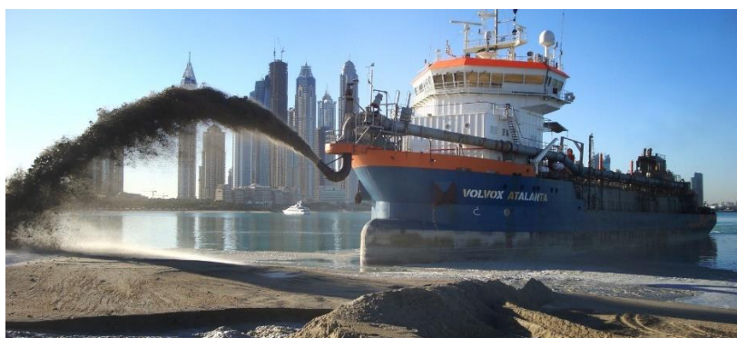
Figuur 57; Onderhoud aan een palmeiland in Dubai (VanOord, 2019).
